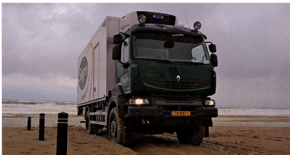
Met zijn speciale banden en grote bodemvrijheid is de Kerax het ideale voertuig voor stranddistributie.
