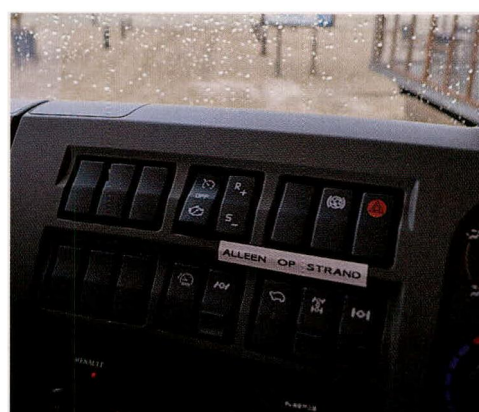
Met een druk op de knop overschakelen op vierwielaandrijving.
